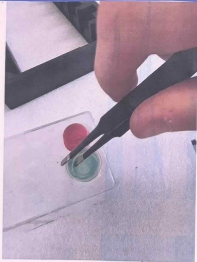
Loctite wird per Pinzette wie Klebstoff angeschmiert.
