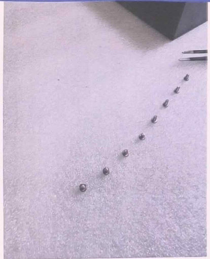
Die Schrauben mussten mit Loctite beschichtet werden damit sie beim Raketen Start nicht heraus wackeln.
