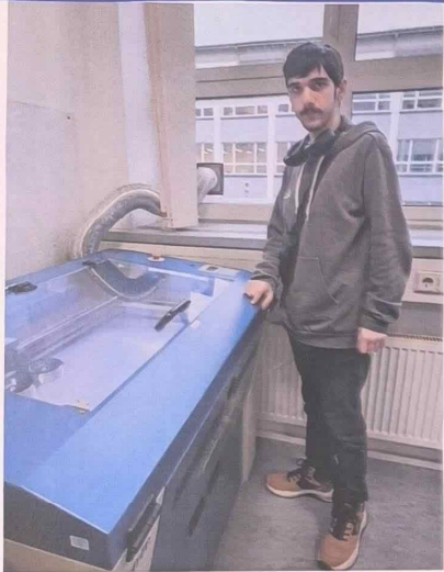
Hier durfte ich den Laserdrucker benutzen um die Rotoren mit Markierungen einzugravieren.
