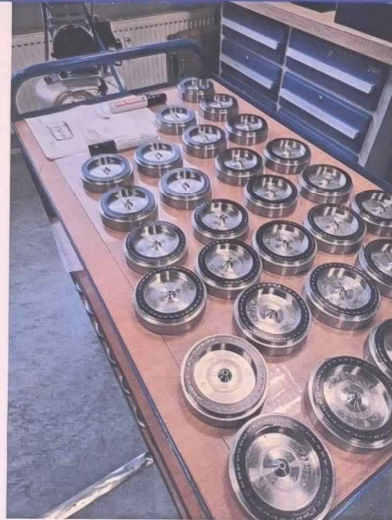
Die Rotoren musste ich wiegen und mit Edding Beschriften um sie zum Lasern vorzubereiten.
